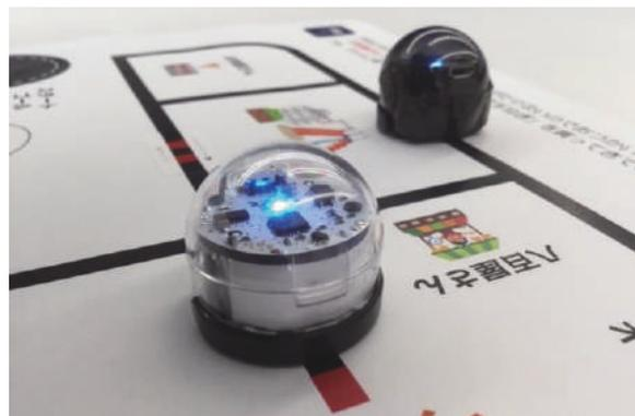
図1 プログラミング教育用ロボット教材 Ozobot
