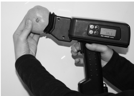
図3 ハンディ型近赤外分光器による、みかん糖度の測定例
