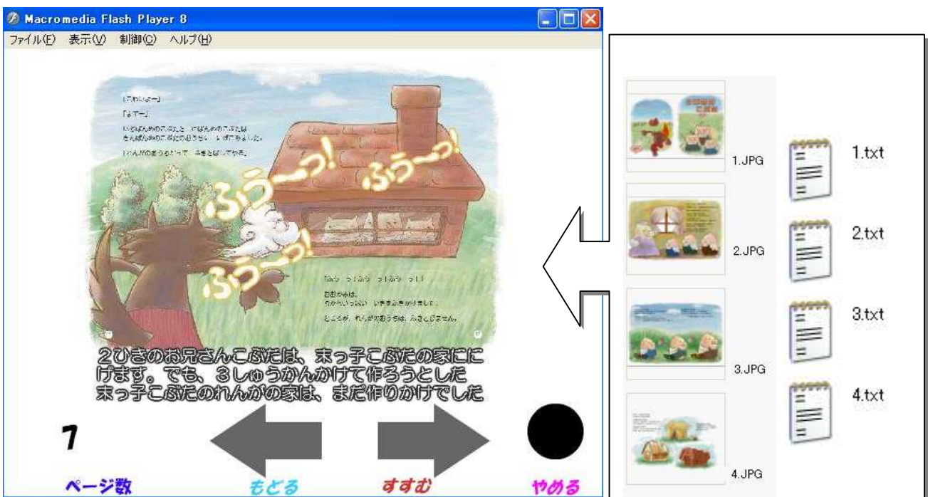
図5 デジタル紙芝居の実行画面（左）と実行のしくみ（この図に示した素材画像は無料素材集 10) によるものを使用した）
