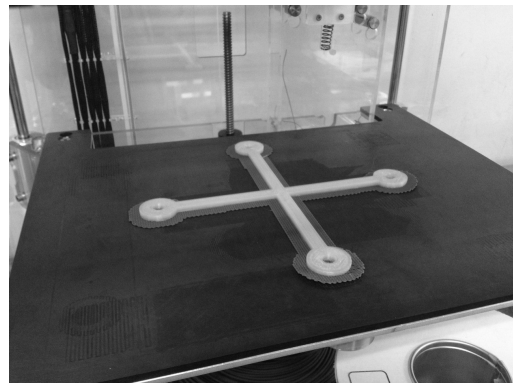
図 3 3 D プリンターで出力したスタビライザー
